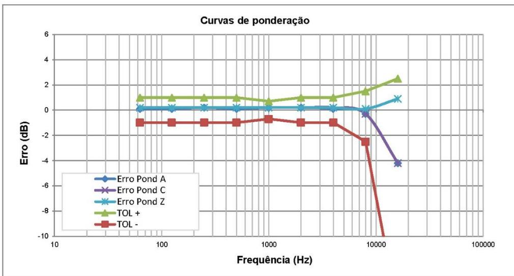
**Teste acústico (normalizado em 1000 Hz)**
