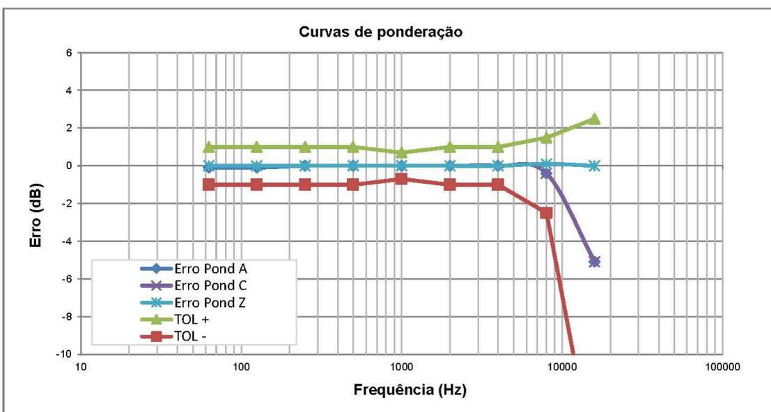
Teste acústico (normalizado em 1000 Hz)
