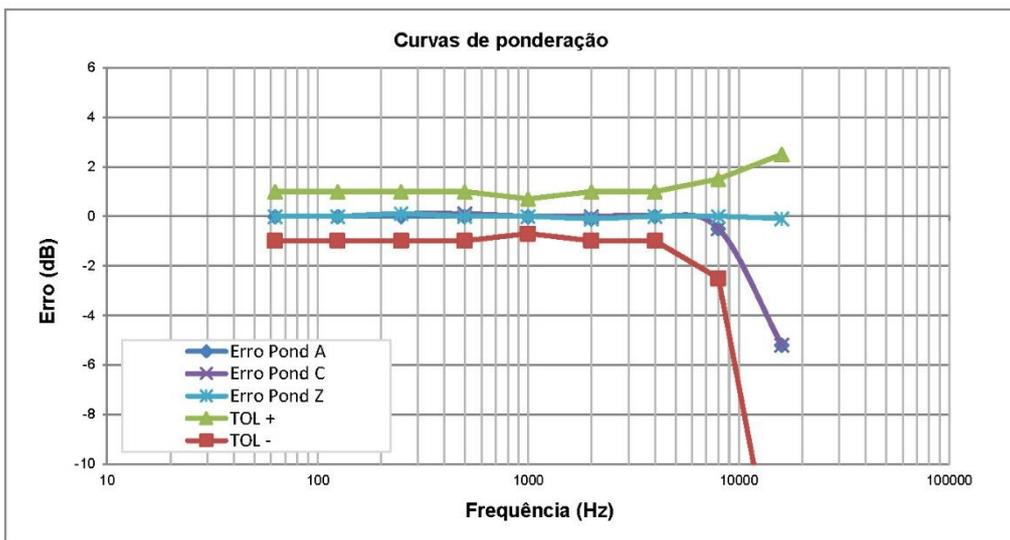
**Teste acústico (normalizado em 1000 Hz)**
